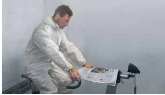
Ölçüm, göğüste 10 sensör ve sırtta 14 sensörle yapılmıştır.
